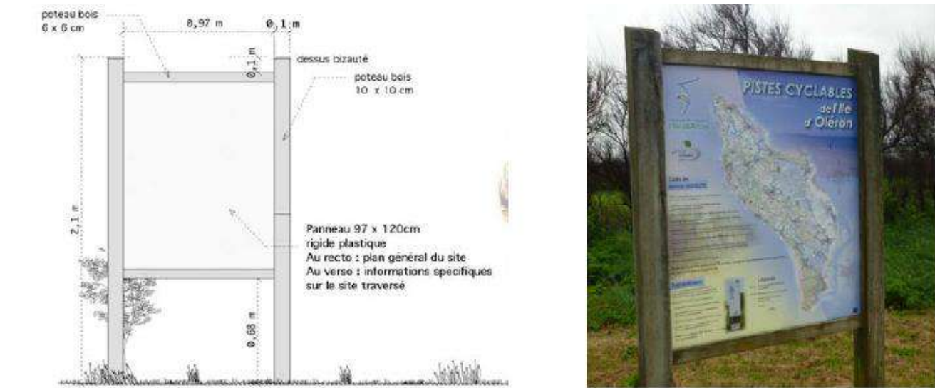
Figure 14 : Panneau d'information – Source : SCE
