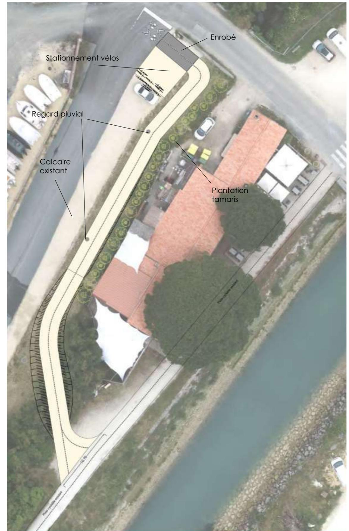
Figure 35 : Plan de principe de la solution 2bis retenue
