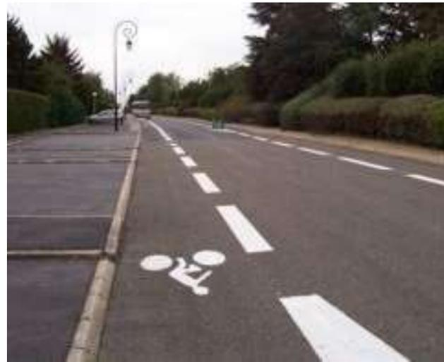
Figure 10 – Exemple de signalétique au sol de voie partagée avec des véhicules motorisés légers
